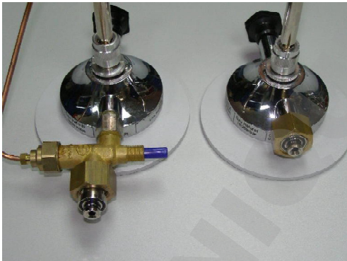
Fig. 3 Burner models with «Loose» connection
