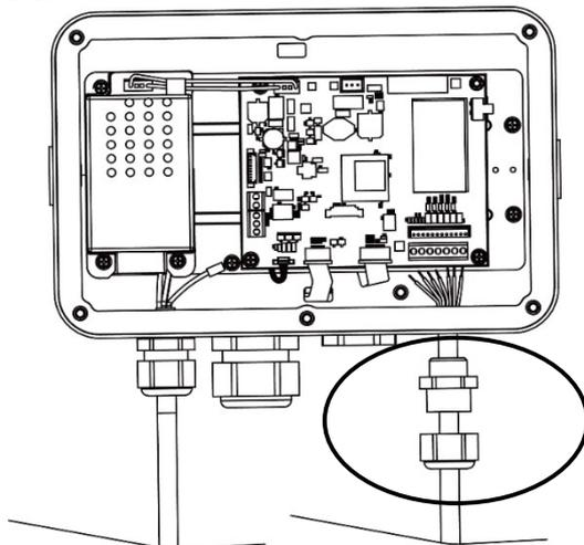
4. Raccordez tous les fils du capteur au bornier du capteur sur la carte mère (entourée). Reportez-vous à la section **Bornier du capteur** pour plus d'informations sur les connexions.
