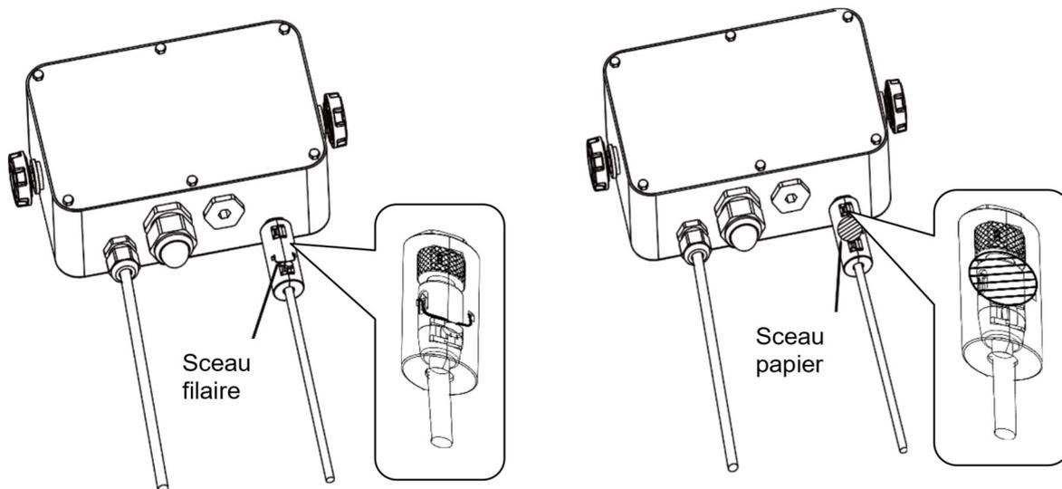
Figure 5-10. Scellage i-DT33XW (câble de raccordement avec connecteur et sans module de mémoire)
