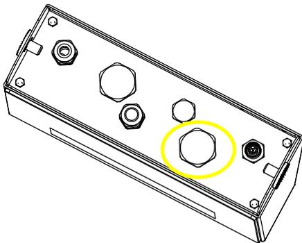
2 Stecken Sie den Wi-Fi/Bluetooth-USB-Dongle durch das M25-Loch.
