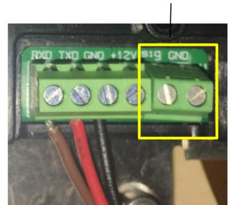
Abbildung 2-7 RS232-Verbindung
