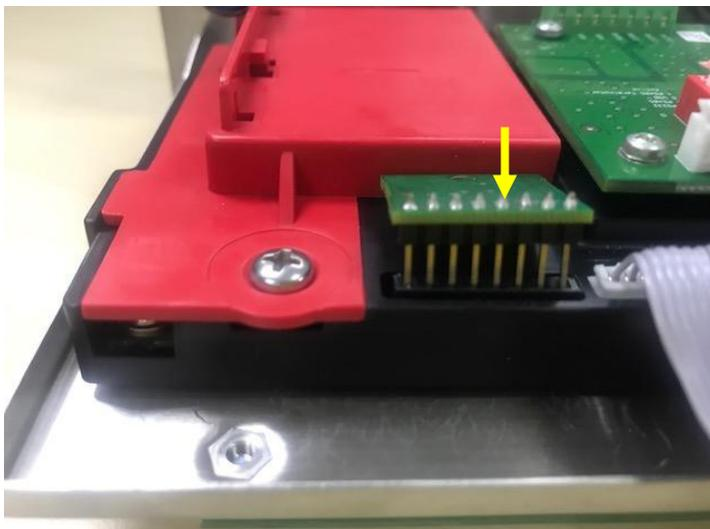
6. Die Schraube mit einem Schraubendreher festziehen und prüfen, dass die Alibi-Speicheplatine richtig sitzt.
