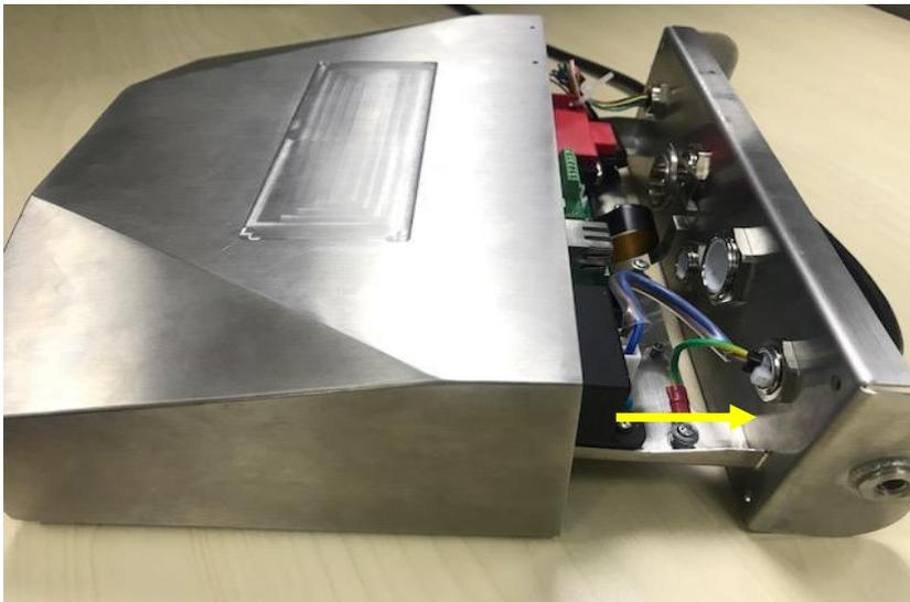
3. Use un destornillador para desatornillar la tapa de sellado.
