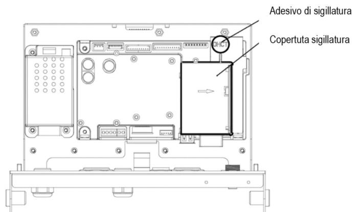
Fig. 5-4. i-DT61XWE Sigillatura con adesivo autodistruggibile.
