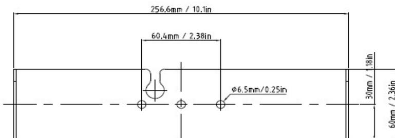
Figura 2.9 Dimensioni staffa di montaggio i-DT61XWE
