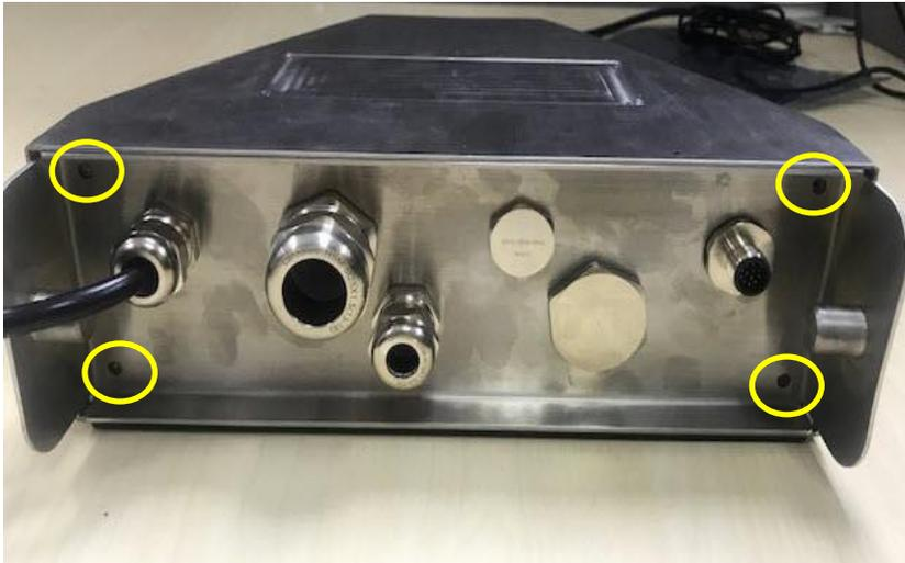
2. Öffnen Sie das Gehäuse, indem Sie die hintere Abdeckung vorsichtig nach hinten ziehen.
