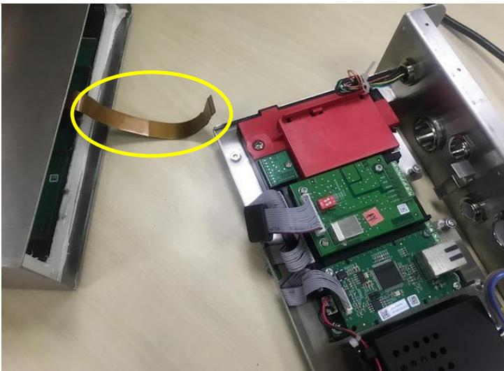
1. una volta terminata l'installazione della scheda di memoria Albi, far passare il cavo della tastiera attraverso il fondo dello strumento.
