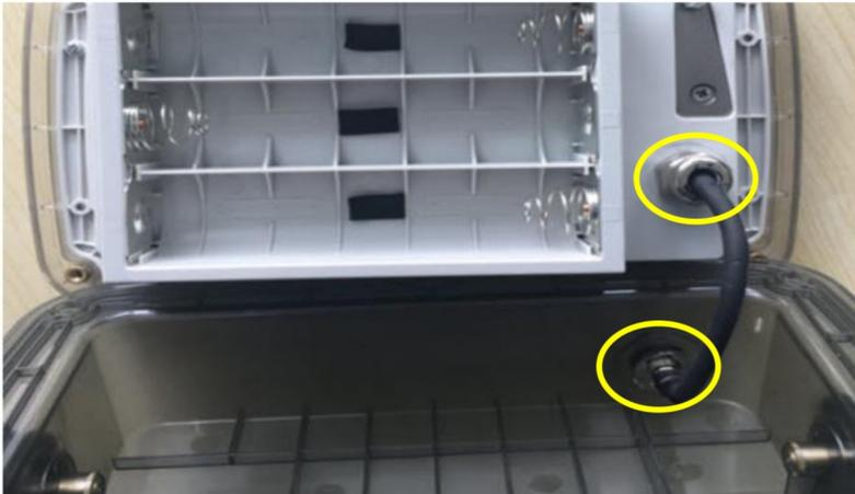
3. Abra la cubierta frontal soltando los 12 tornillos de cabeza Phillips.
