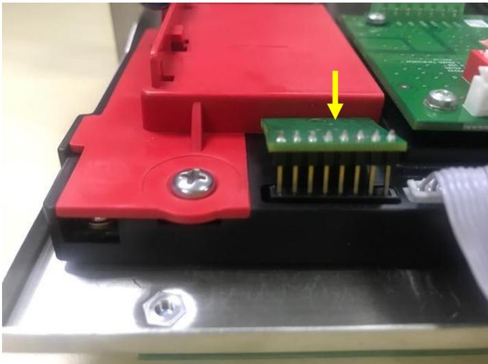
6. Use un destornillador para apretar el tornillo, y asegúrese de que la tarjeta de memoria Alibi está instalada correctamente.
