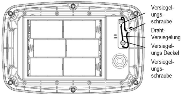
Abbildung 5-1. i-DT61PW Draht-Versiegelung
