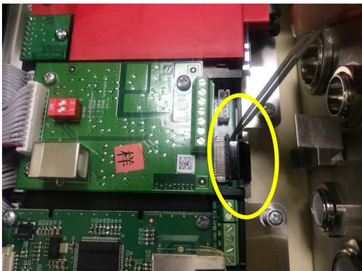
4. Prüfen Sie, dass der gesamte FPC-Sockel eingeschoben und das Tastenkabel fest daran befestigt ist.
