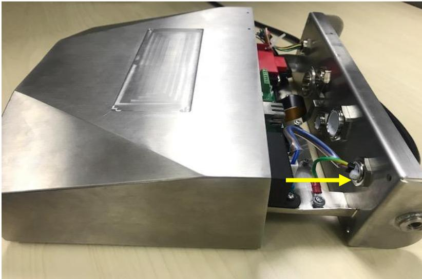
3. Verwenden Sie einen Schraubenzieher, um den Dichtungsdeckel abzuschrauben.
