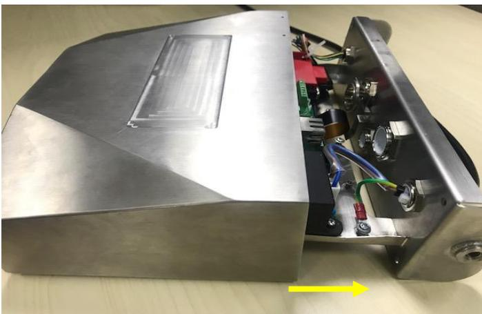
4. Extraiga la tarjeta de memoria Alibi y prepare la instalación en el lugar marcado con el círculo.
