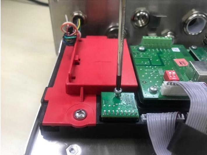
7. Das Unterteil des Terminals einziehen und prüfen, dass alle in Schritt 2 markierten Schrauben angezogen sind.
