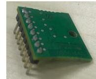
5. Stecken Sie die Alibi-Speicherplatine, wie nachstehend dargestellt, in den Steckplatz ein. Bitte stellen Sie sicher, dass die Kontakte richtig eingesetzt sind.
