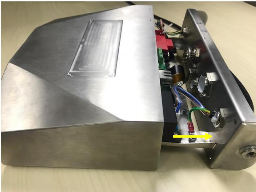
3. Una vez que estén realizadas todas las conexiones, vuelva a colocar la cubierta inferior.
