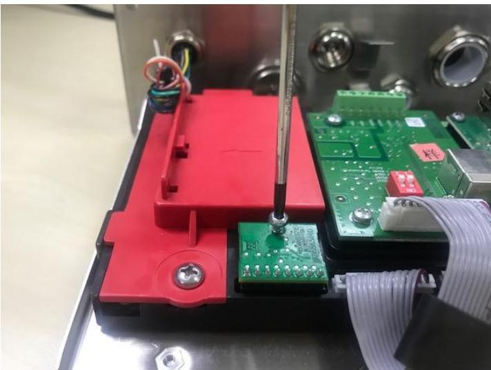
7. Apriete la parte inferior del terminal, y asegúrese de que todos los tornillos marcados en el paso 2 estén apretados.
