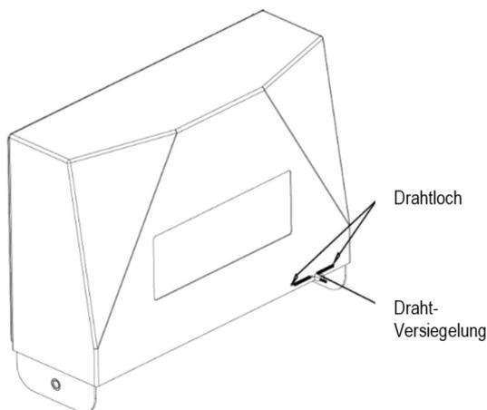
Abbildung 5-3. i-DT61PW Draht-Versiegelung
