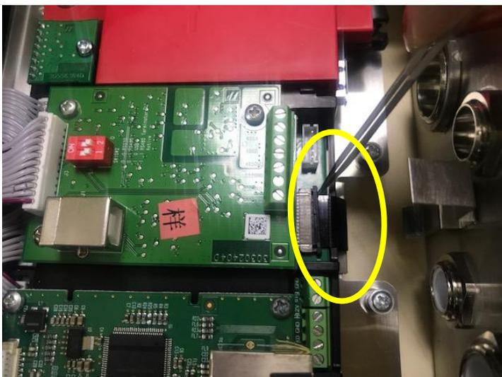
4. Assicurarsi che l'intera presa FPC sia inserita e che il cavo della tastiera sia fissato saldamente ad essa.
