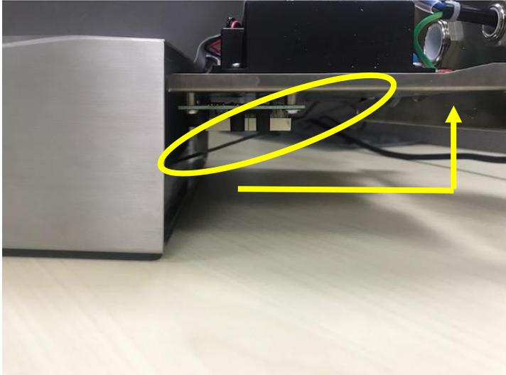
2. Ziehen Sie es unter den FPC-Sockel. Das Tastenkabel weiter unter den FPC-Sockel drücken, so dass das Kabel festsetzt.
