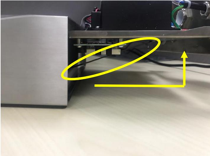
2. E tirarlo sotto la presa FPC. Spingere ulteriormente il cavo della tastiera sotto la presa FPC in modo che il cavo sia saldamente fissato.
