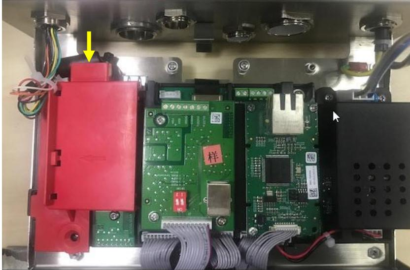
5. Extraiga la tapa de sellado y desconecte los conectores blancos de células de carga.
