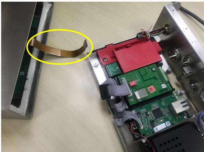
1. Nach Installation der Albi-Speicherplatine, führen Sie das Tastenkabel durch den Boden des Messgeräts.
