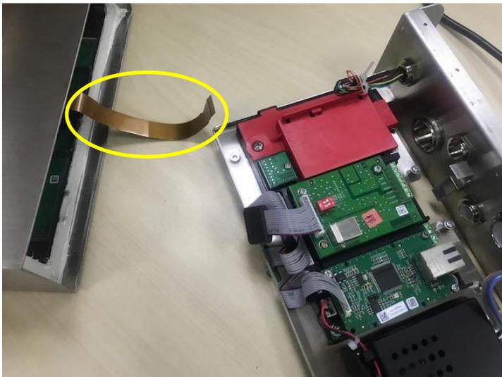
1. Cuando termine de instalar la tarjeta de memoria Alibi, pase el cable inferior por debajo del medidor.
