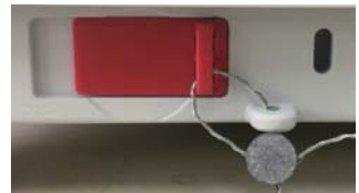
Bloccato con Sigillo di Cavo
