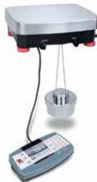
Crochet de pesée sous balance en utilisation
