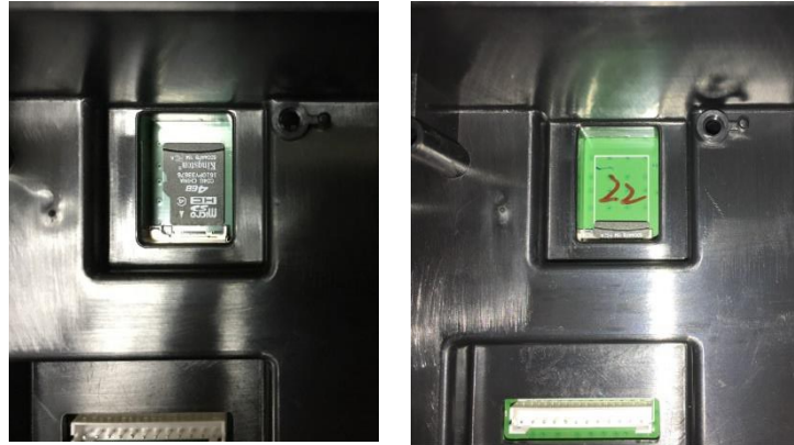
Figura 2-5 Scorrimento di una Scheda SD nella Presa SD (a sinistra); Scheda SD Installata (a destra)
