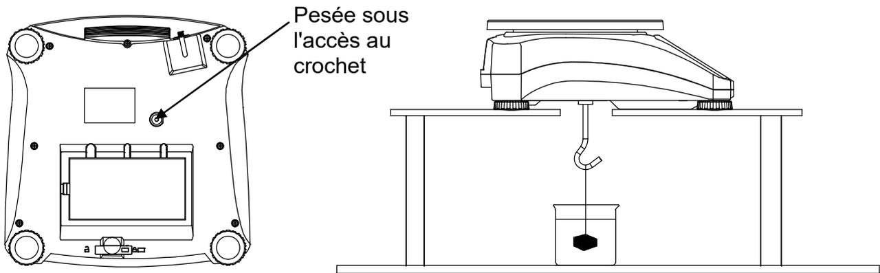
Figure 4-1. Configuration pour un crochet sous la pesée
