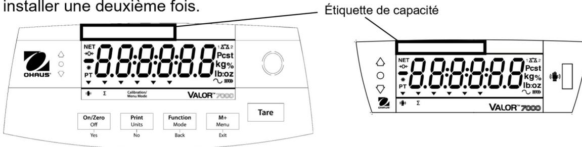
Figure 5-1. Emplacements avant et arrière des étiquettes de capacité
