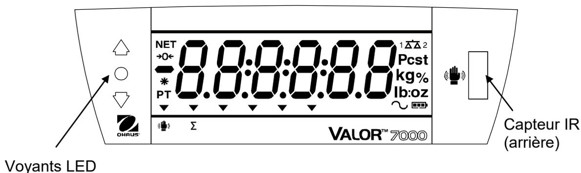
Figure 3-3. Affichage LCD rétroéclairé Valor 7000
