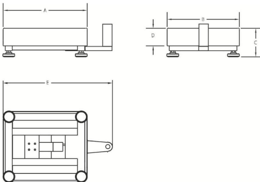
Figure 1. plan d'encombrement de la base Defender.
