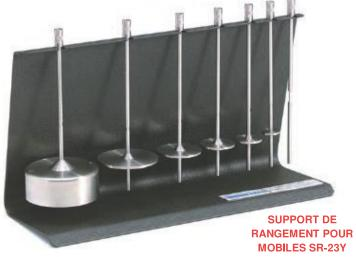
Le jeu de mobiles RV/HA/HB contient les mobiles #2 à #7 et est fourni avec les viscosimètres et rhéomètres Brookfield standard.
