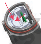
Figura 4: Pressione para baixo para bloquear
