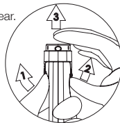
Figura 1: Extracción de la cubierta de las pilas
