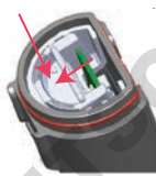
Figure 4 : Poussez vers le bas pour verrouiller
