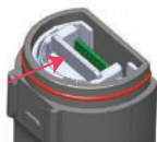
Figura 2: Pressione para desbloquear
