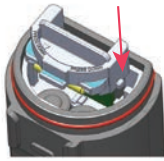
Abbildung 3: Richten Sie die Registerkarten aus
