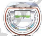
Figura 5: Posição de desbloqueio da placa de pilhas
