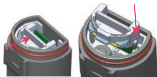
図 2: 押してロックを解除する
