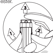
Afbeelding 1: Verwijderen van het batterijklepje
