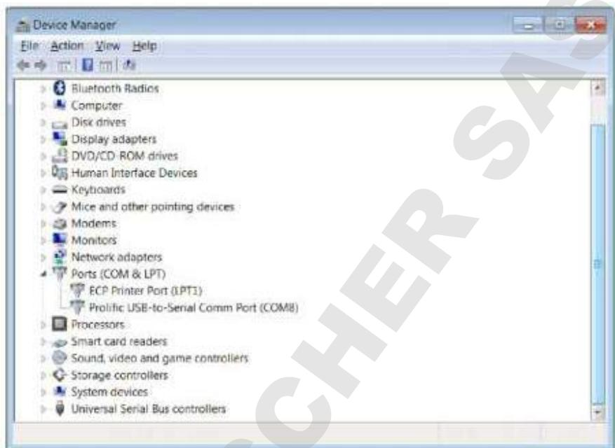
5. L'instrument de mesure peut désormais transférer des données à l'ordinateur à l'aide du port Virtual COM et du logiciel Orion Star Com, HyperTerminal ou autre programme similaire.
