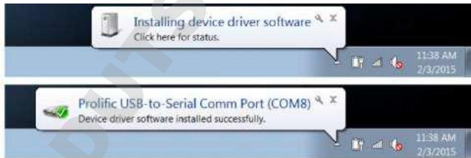
4. Enregistrez l'emplacement du port COM du câble USB-série, par exemple COM8. Pour afficher l'emplacement du port COM, ouvrez l'outil Gestionnaire de périphériques de l'ordinateur et développez l'option Ports.
