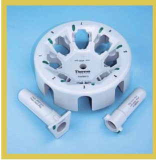
Rotor DualSpin unique avec conception hybride
