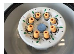
Rotor DualSpin avec nacelles oscillantes
