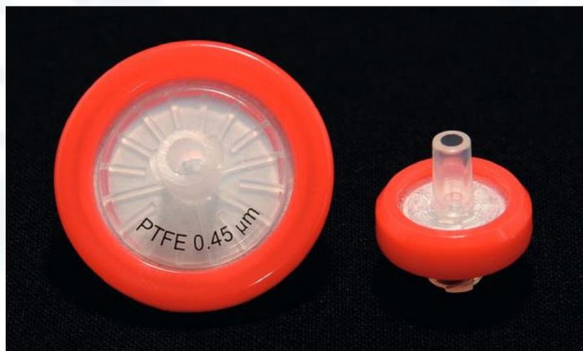
Fabriquées avec des membranes en polytétra-fluoréthylène, ces filtres seringues hydrophobes peuvent être utilisés pour la stérilisation de l'air ou la préparation d'échantillons HPLC. Pour la filtration de solutions aqueuses, il conviendra au préalable d'imbiber avec un solvant adapté (éthanol, méthanol...).
