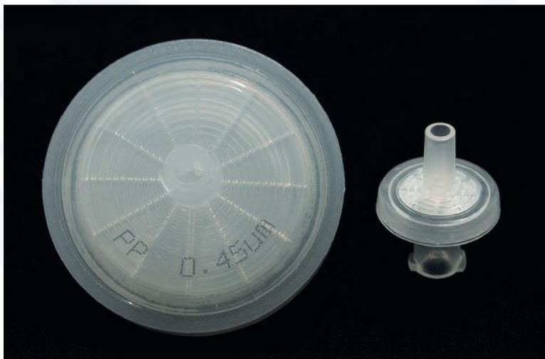
D'une excellente compatibilité chimique et hydrophobes, les filtres seringues en polypropylène sont adaptés pour les échantillons HPLC comportant peu de solides ou pour les échantillons de volume faible.
