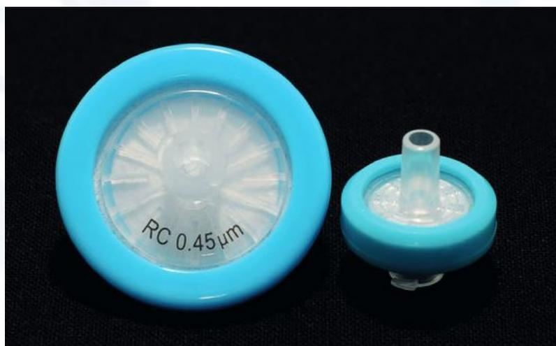
Les filtres seringues en cellulose régénérée sont recommandés pour la filtration directe de solutions aqueuses ou de tout type de solvant organique. On les utilise pour leur grande capacité à extraire les particules.
