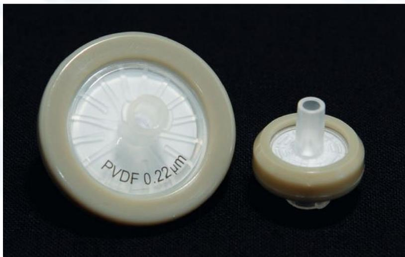
Composées de membranes hydrophobes, les filtres seringues en polyvinylidène sont d'une excellente résistance chimique contre la majorité des solvants organiques et autres composants agressifs. Ils conviennent pour la filtration de l'air ou de gaz.
