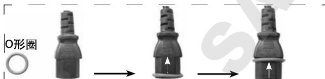
为防止水进入连接器内，请将O形圈缠绕于电源线插头上。
