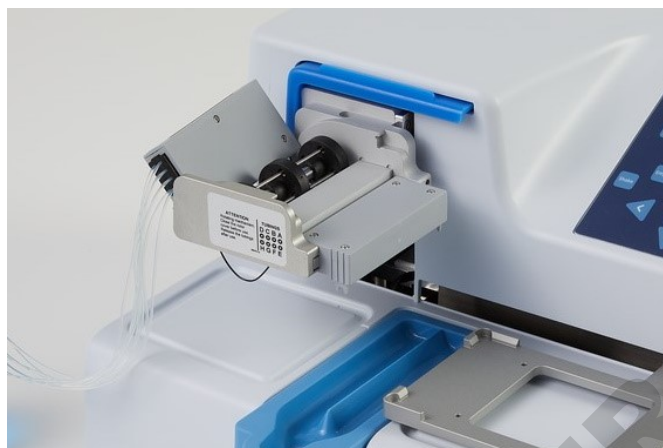
Figure 5–29. Position de repos de la cassette de distribution
