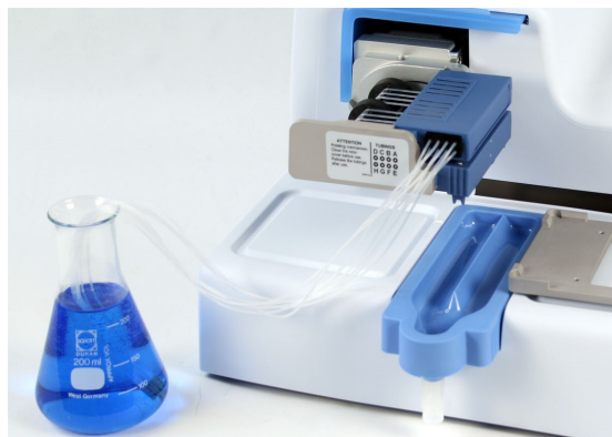
Figure 4–20. Cassette avec les protections de poids de tubulure et d'aiguille retirées et le poids de tubulure dans le récipient de réactif
