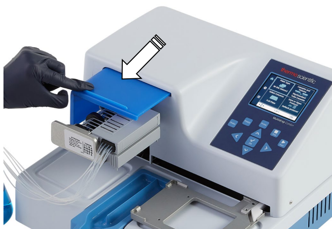
Figure 4–22. Traction du cache de rotor sur le rotor
