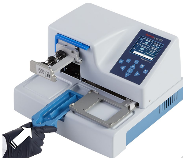
Figure 3–8. Insertion du récipient d'amorçage
