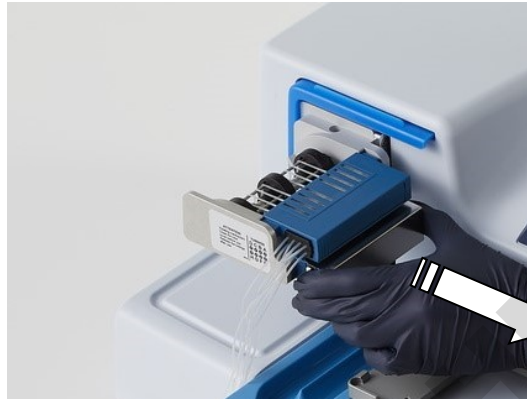
Figure 4–18. Retrait de la protection d'aiguille hors de la cassette de distribution
