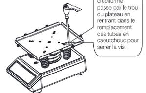
Le tournevis cruciforme passe par le trou du plateau en rentrant dans le remplacement des tubes en caoutchouc pour serrer la vis.
