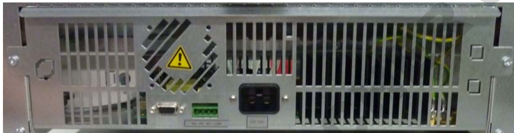
Figure 4-16 Interfaces de signal et prise d'alimentation
