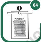
Retirer les Wipa-Boots et remettre à l'intérieur du sac d'échantillonnage stérile
