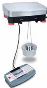
Crochet de pesée sous balance en utilisation
