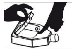
1 Hier drücken Press here 2 Deckel herausheben Lift out lid
