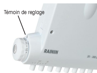
Figure 35 : Témoin de réglage du limiteur
