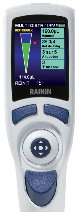
Figure 3 : Commandes de la pipette E4 XLS
