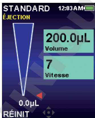
Figure 13 : Éjection en mode Standard.
