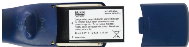
Figure 5 : Installation de la batterie principale
