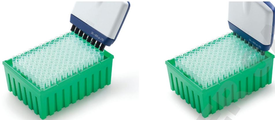
Figure 33 : Montage d'une rangée de cônes LTS
