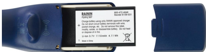
Figure 5 : Installation de la batterie principale
