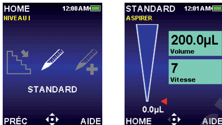
Figure 8 : Mode Standard en surbrillance dans le menu de niveau I (gauche), Ecran opérationnel du Mode Standard (droite).
