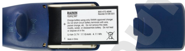
Figure 28 : Remplacement de la batterie
