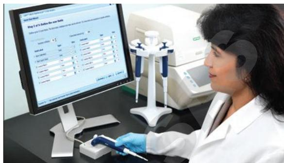
Il lettore RFID opzionale funziona con tutte le pipette Rainin con tecnologia RFID e si interfaccia con il software LabX™ Direct Pipette-Scan™ di METTLER TOLEDO per il controllo della taratura.
