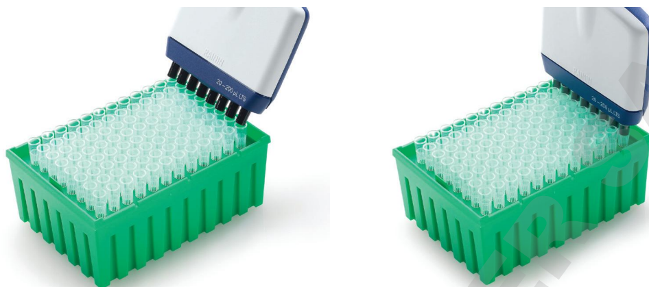
Figure 33 : Montage d'une rangée de cônes LTS
