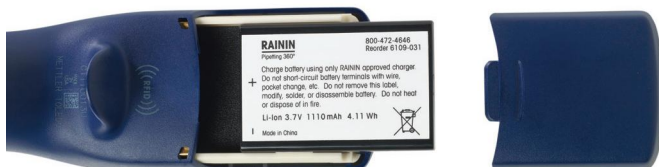
Figure 5 : Installation de la batterie principale
