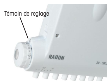
Figure 35 : Témoin de réglage du limiteur
