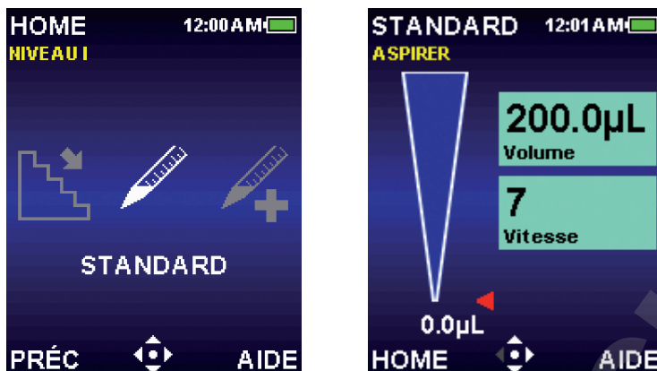
Figure 8 : Mode Standard en surbrillance dans le menu de niveau I (gauche), Ecran opérationnel du Mode Standard (droite).
