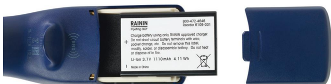
Figure 5 : Installation de la batterie principale
