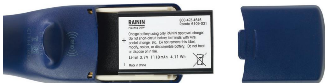
Figure 5 : Installation de la batterie principale
