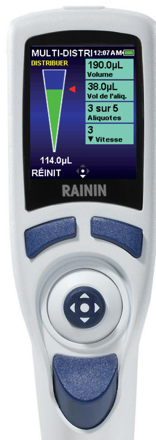
Figure 3 : Commandes de la pipette E4 XLS
