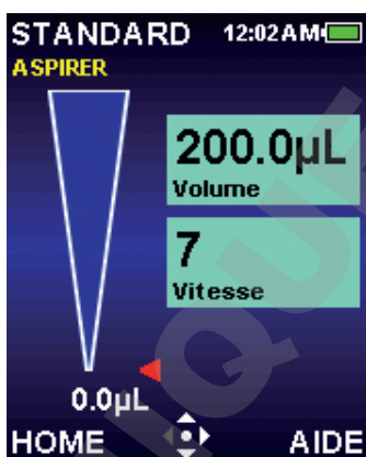
Figure 11 : Aspiration en mode Standard.
