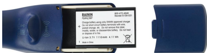
Figure 5 : Installation de la batterie principale
