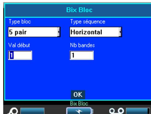
Dans les applications 110- et Bix-Bloc, le nombre de zones créées se base sur la configuration de paire sélectionnée. Les lignes de séparation verticales et horizontales sont automatiquement ajoutées.
