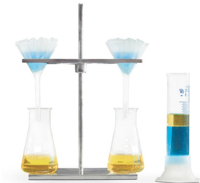
Le grade 480 est imprégné de silicone stabilisé, ce qui le rend hydrophobe : il retient l'eau, mais laisse passer les solvants. Le flux s'arrête automatiquement une fois que le solvant a entièrement traversé le papier filtre. Dans de nombreuses applications, ce papier séparateur de phases peut être utilisé à la place d'ampoules à décanter.
