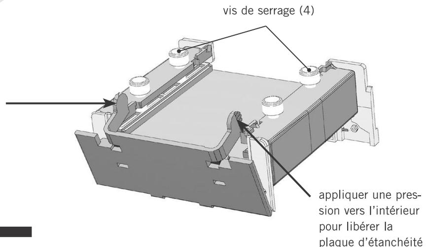
**Fig 3.** Module dans la position ouverte.
