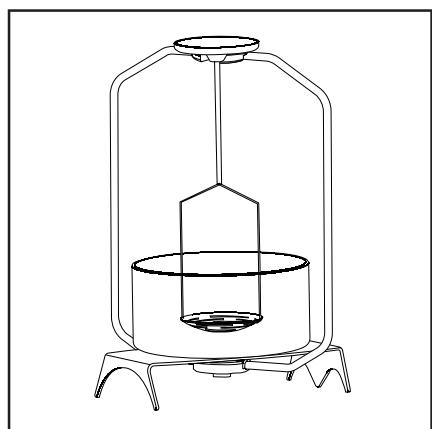
Dichtebestimmung von Festkörpern, Dichte höher als die der Tauchflüssigkeit:
