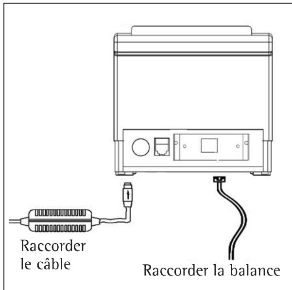
Avant de raccorder l'imprimante comme indiqué sur la figure ci-dessus, assurez-vous que l'interrupteur principal est en position OFF.
