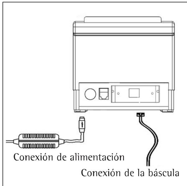
Antes de conectar la impresora tal y como se muestra en la figura es necesario asegurarse de que el interruptor de corriente está en posición OFF.
