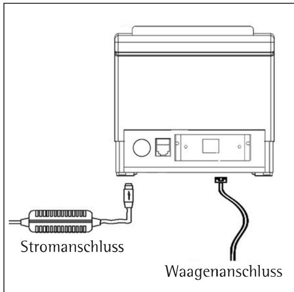
Bitte vergewissern Sie sich, dass der Stromschalter in Stellung AUS steht, bevor Sie den Drucker in Übereinstimmung mit der obigen Abbildung anschließen.
