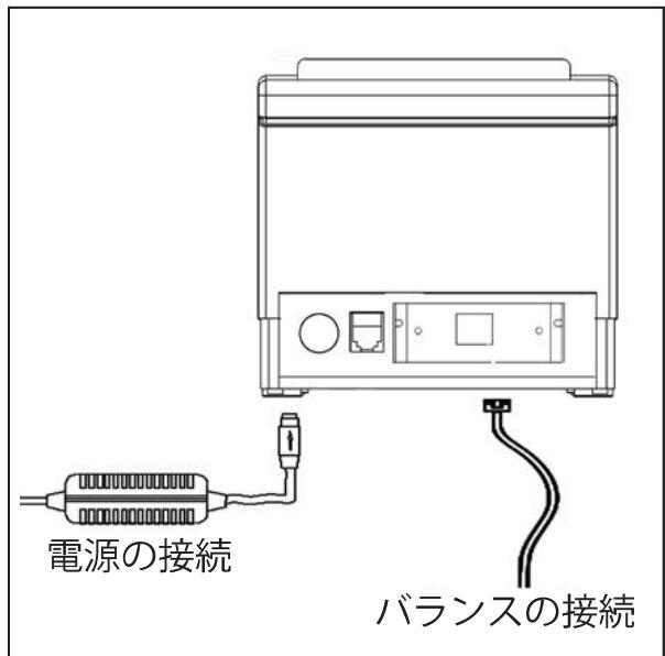
上の図に従ってプリンタを接続する前に、プリンタの電源スイッチをチェックしオフの位置にあることを確認してください。
