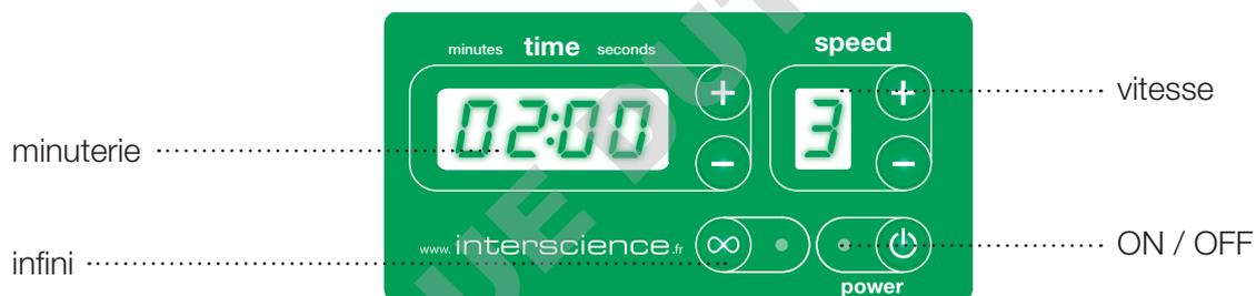
3. Régler également la vitesse de malaxage des pales (1, 2, 3 ou 4) à l'aide des touches "Speed" situées sur le clavier.
