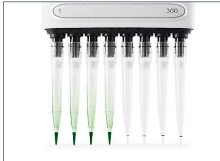
Les quatre embouts à faible rétention à droite retiennent une quantité minimale de liquide résiduel.
