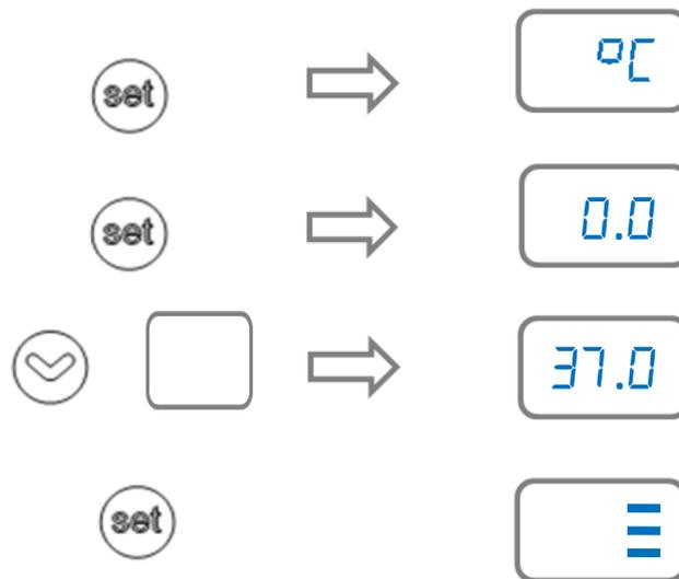
Figure 2 – Réglage de la température du bain
