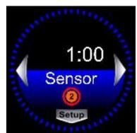
Aktivieren Sie den Brenner im Sensorbetrieb durch eine Hin- und Herbewegung in kurzem Zeitabstand vor dem Sensor.
