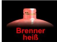
Der schuett phoenix II ist für den Dauerbetrieb (120 min) ausgelegt. Bei voll geöffneter Gas- und Luftzufuhr überhitzt sich der Brenner nicht. Sollte der Brenner durch ungünstige Bedingungen wie Rückstrahlungswärme oder ungünstig eingestellte Flamme zu heiß werden, schaltet sich das Gerät automatisch ab. Der Hinweis „Brenner heiß“ wird im Display angezeigt.
