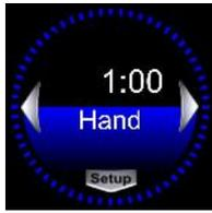
Zünden Sie die Flamme durch kurzes, mittiges Drücken auf den Joystick. Die Flamme brennt, bis die eingestellte Brennzeit abgelaufen ist. Zum Unterbrechen nochmals kurz den Joystick mittig drücken.
