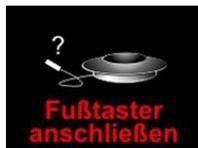
Bei nicht angeschlossenem Fußtaster zeigt der Brenner bei Auswahl der Betriebsart „Fuß“ nach kurzer Zeit folgenden Hinweis an: „Fußtaster anschließen“. Bitte schließen Sie den Fußtaster an (siehe „Inbetriebnahme“, Seite 9).
