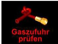
Wird beim automatischen (Wieder-)Zünden nach 10 Sekunden keine Flammenbildung erreicht, schließt der schuett phoenix II die Gaszufuhr automatisch und dauerhaft. Im Display wird der Hinweis „Gaszufuhr prüfen“ angezeigt. Siehe „Maßnahmen zur Problembeseitigung“, Seite 31.
