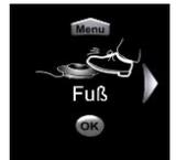
Bei nicht angeschlossenem Fußtaster zeigt der Brenner bei Auswahl der Betriebsart „Fuß“ nach kurzer Zeit folgenden Hinweis an: „Fußtaster anschließen“. Bitte schließen Sie den Fußtaster an (siehe Inbetriebnahme, Seite 9).
