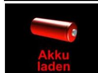
Der Akku hat seine Mindestspannung unterschritten. Laden Sie den Akku am Netzanschluss mit dem mitgelieferten Ladegerät wieder auf.
